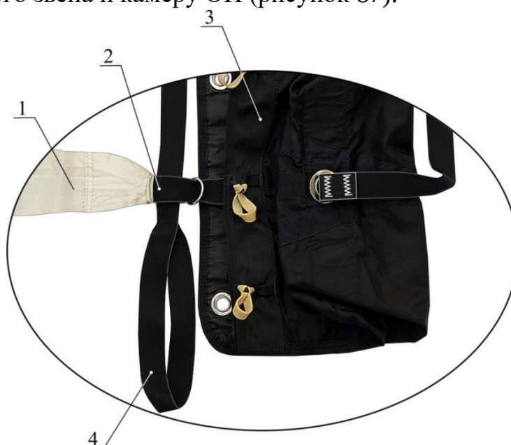
Рисунок 87 – Монтаж вытяжного звена ОП
