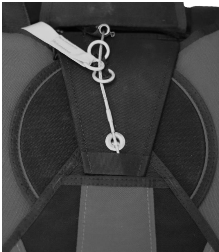
Рисунок 75 – Зачековка верхнего клапана контейнера ЗП и монтаж кольца звена раскрытия «Транзит»
