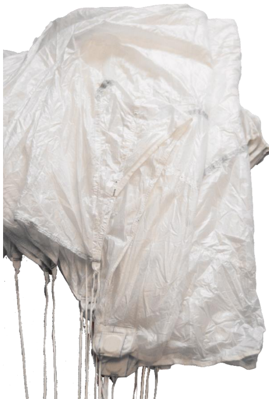
Рисунок 52 – Укладка полотнища между стропами 4-го ряда и СУ
