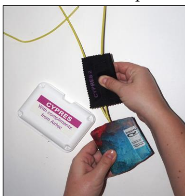
Рисунок 91 – Смазывание тросов звена отсоединения ОП
