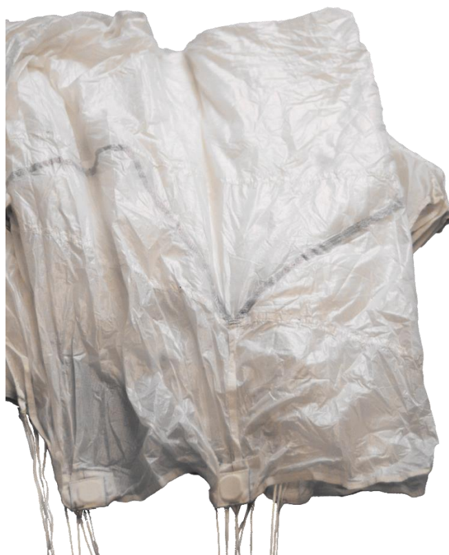
Рисунок 50 – Укладка полотнищ между стропами 2 и 3 ряда
