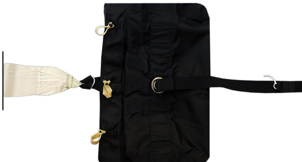
Рисунок 88– Монтаж вытяжного звена ОП
