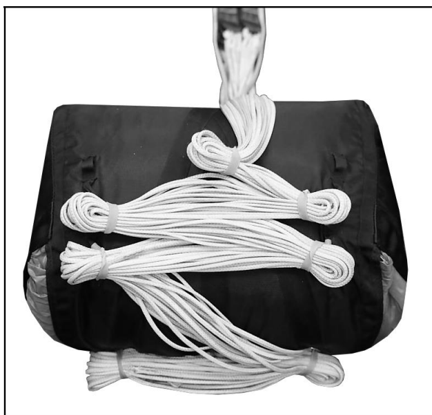
Рисунок 112 – Укладка строп (вид с обратной стороны камеры)
