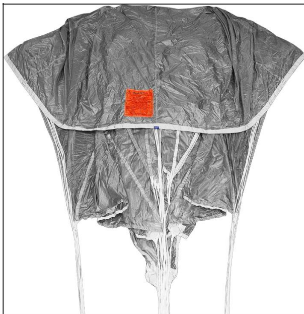
Рисунок 104 – Расположение строп 4-го ряда
