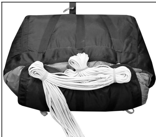
Рисунок 111 – Зачековка стропами камеры ОП
