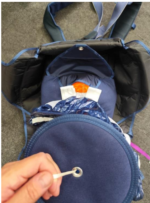
Рисунок 71 – Продевание стропы – затяжки сквозь пружинный ВП
