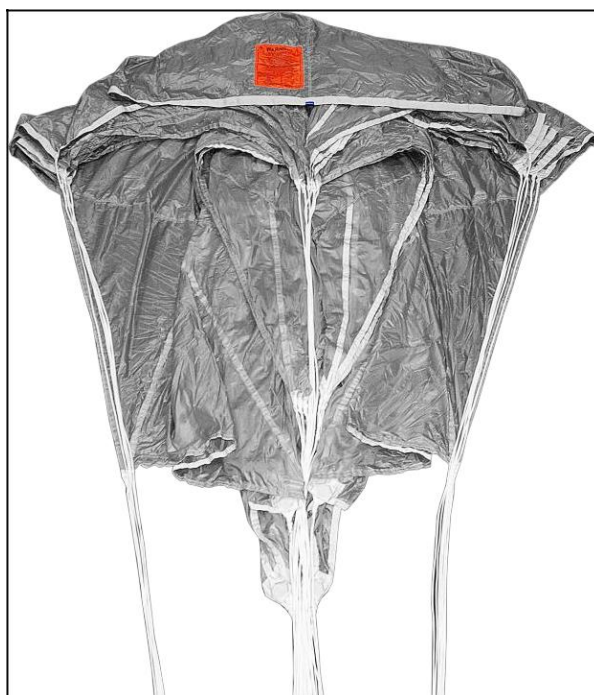
Рисунок 103 – Укладка задней кромки купола
