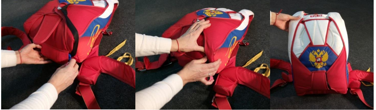
А Б В Рисунок 120 – Укладка МВП в эластичный карман, закрытие предохранительного клапана
