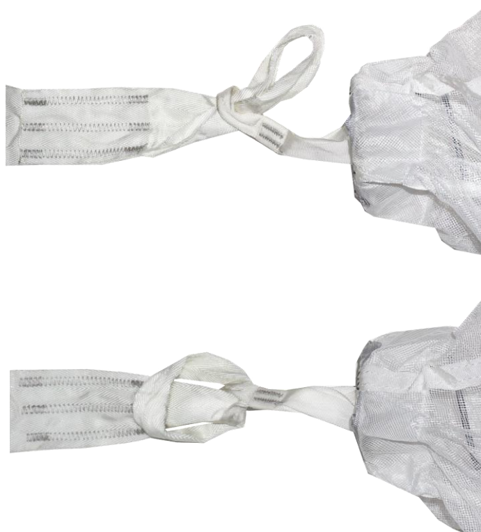
Рисунок 44 – Монтаж пружинного ВП на звено камеры ЗП
