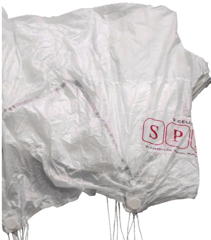
Рисунок 49 – Укладка полотнищ между стропами 1 и 2 ряда
