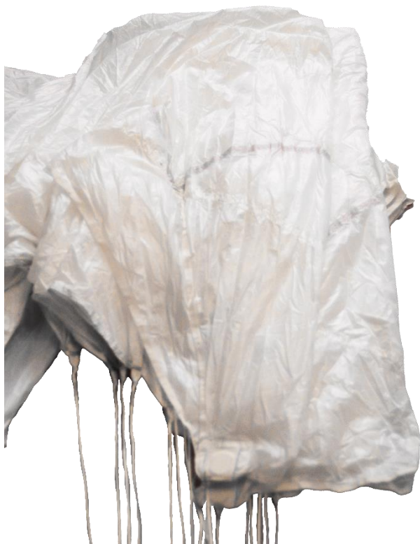
Рисунок 51 – Укладка полотнищ между стропами 3 и 4 ряда
