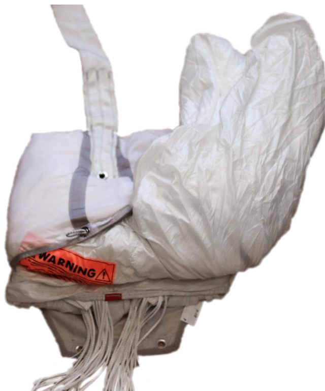
Рисунок 64 – Укладка в камеру ЗП «третьего сложения»
