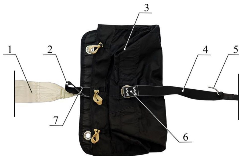
Рисунок 86 – Монтаж вытяжного звена ОП
