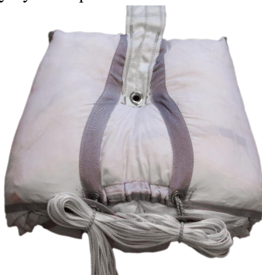
Рисунок 65 – Камера ЗП с уложенным куполом и зачекованной «плавающей» сотой
