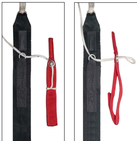
Рисунок 84 – Монтаж СУ (с петлёй) на звено управления основное
