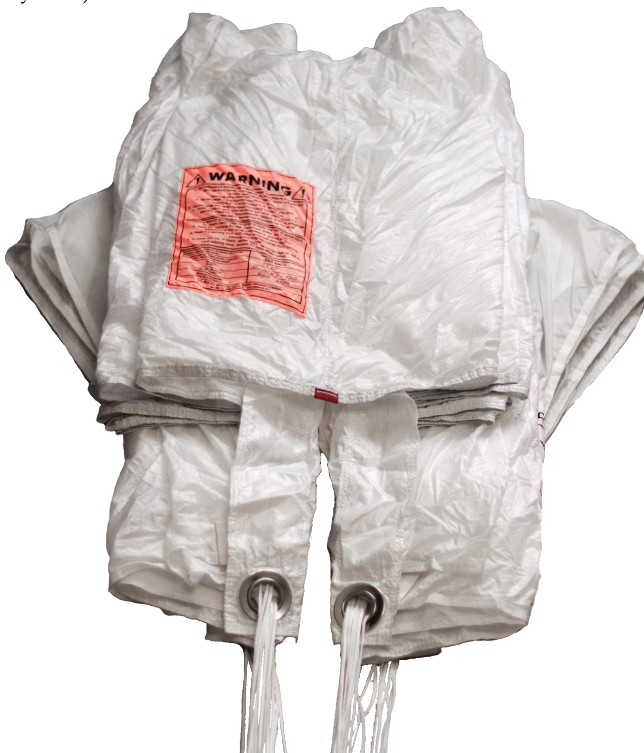
Рисунок 57 – Укладка хвостовой части купола
