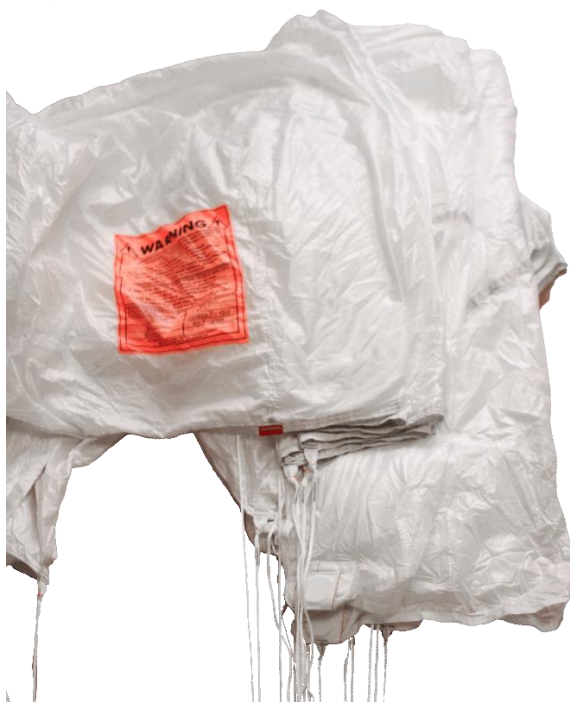
Рисунок 53 – Укладка задней кромки купола
