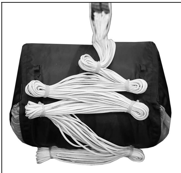
Рисунок 108 – Укладка строп (вид с обратной стороны камеры)
