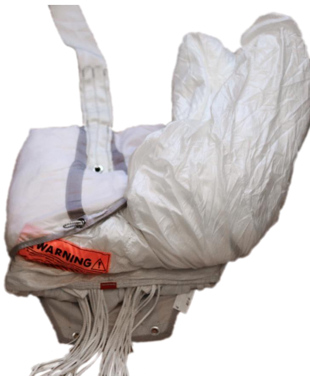
Рисунок 62 – Укладка в камеру ЗП «третьего сложения»
