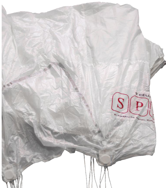
Рисунок 47 – Укладка полотнищ между стропами 1 и 2 ряда
