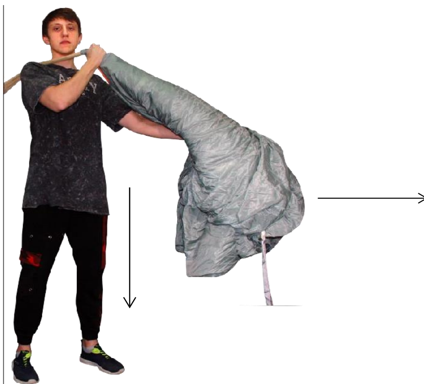
Рисунок 127 – Укладка ОП на укладочную поверхность
