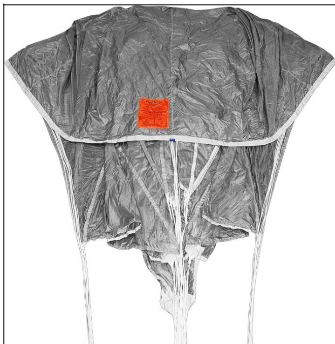
Рисунок 100 – Расположение строп 4-го ряда
