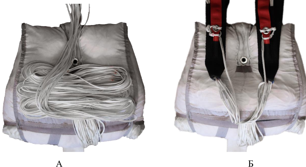
Рисунок 64 – Укладка строп в камеру ЗП
