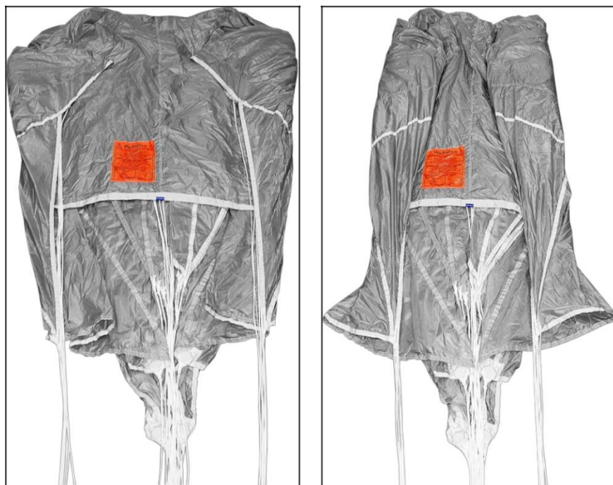
Рисунок 101 – Сворачивание левой и правой задней кромки купола Расправить стабилизирующие полотнища купола (рисунок 102).
