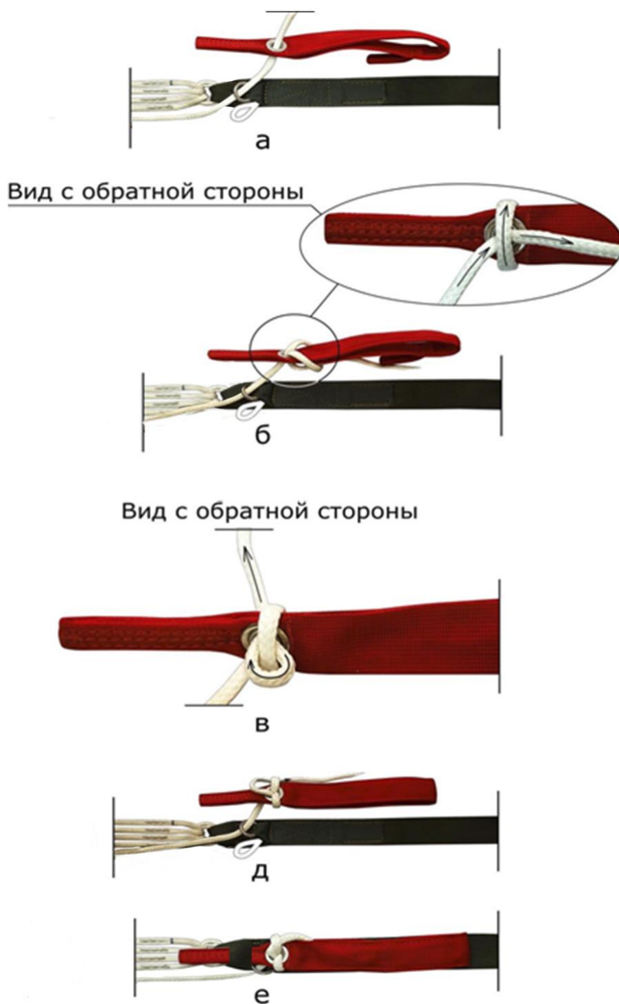
Рисунок 79 – Монтаж основной СУ на звено управления
