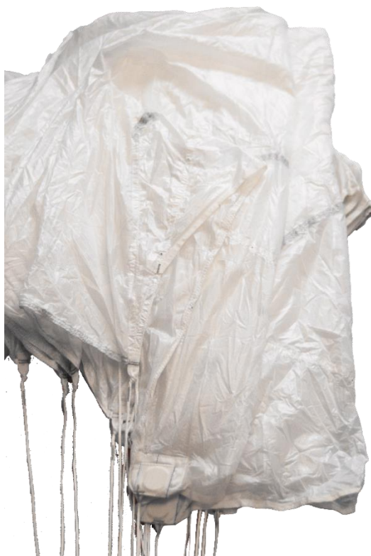
Рисунок 50 – Укладка полотнища между стропами 4-го ряда и СУ
