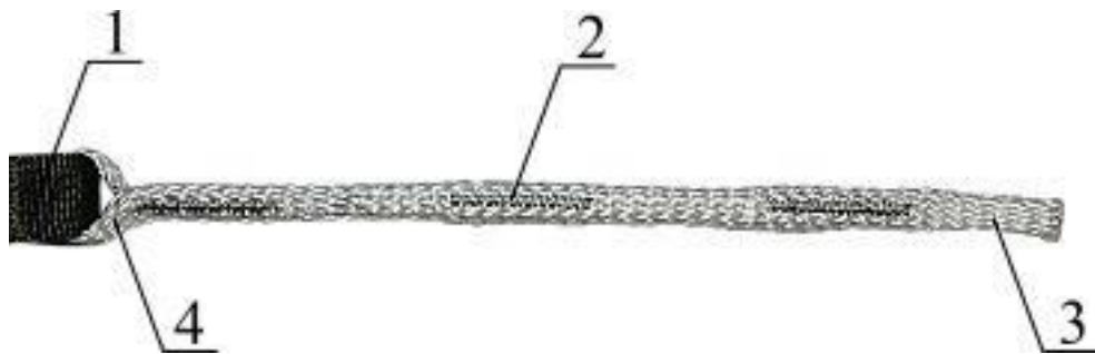
Рисунок 22 – Звено соединительное «софтлинк»
