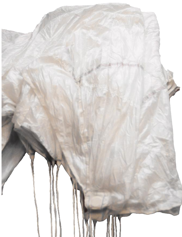
Рисунок 49 – Укладка полотнищ между стропами 3 и 4 ряда
