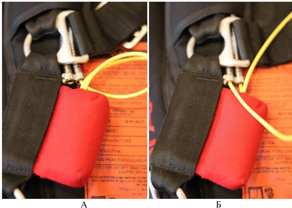
Рисунок 87 – Установка звена отсоединения ОП
