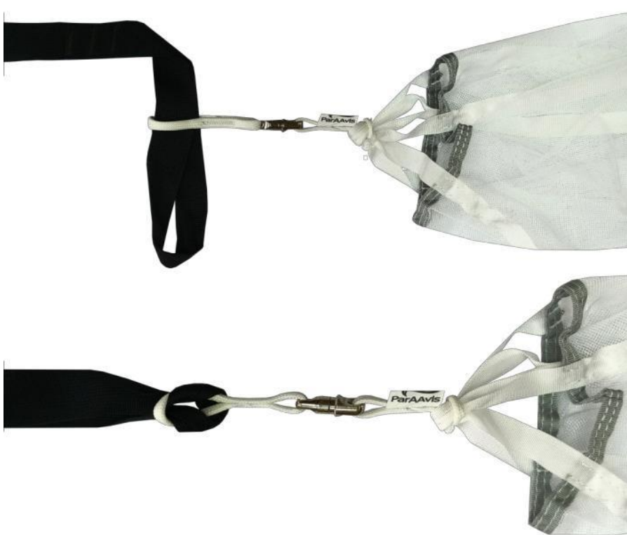
Рисунок 85 – Монтаж МВП на вытяжное звено (узел-удавка условно не затянут)
