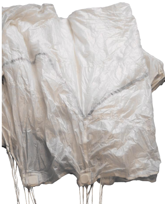
Рисунок 48 – Укладка полотнищ между стропами 2 и 3 ряда
