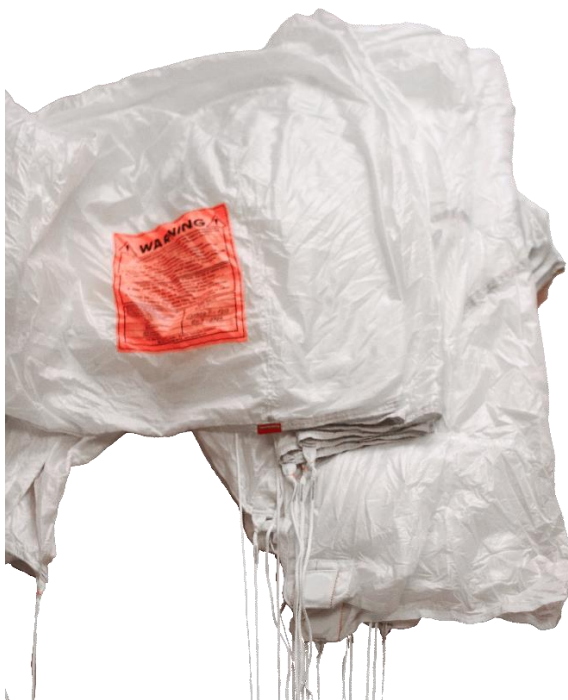
Рисунок 51 – Укладка задней кромки купола
