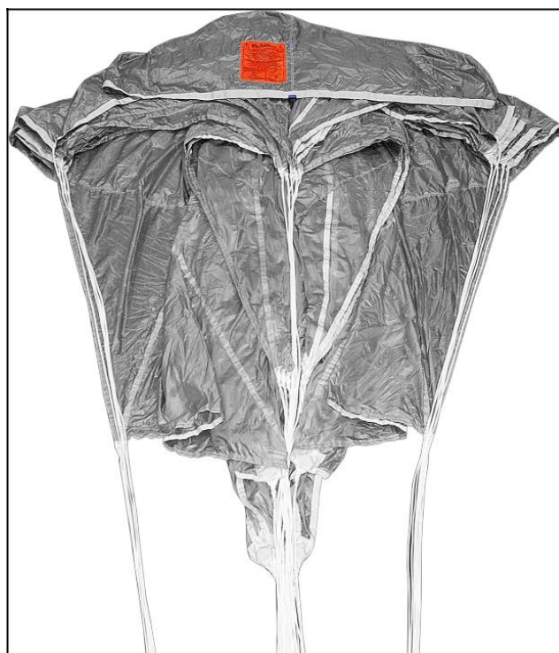
Рисунок 99 – Укладка задней кромки купола
