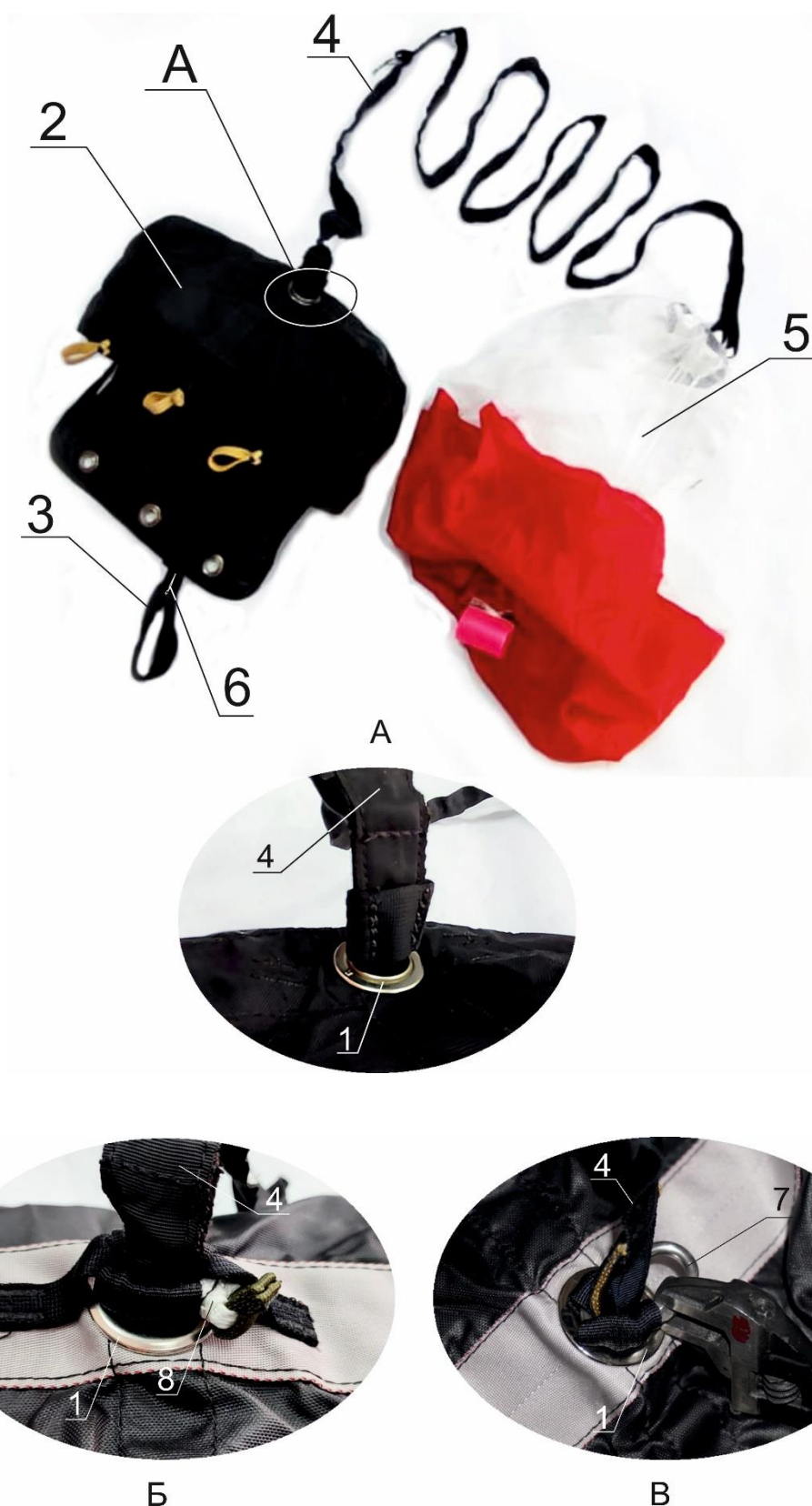
Рисунок 19 – Камера ОП и вытяжное звено с «коллапсом» 1 – люверс камеры; 2 – камера основного парашюта; 3 – петля звена; 4 – звено; 5 – парашют вытяжной; 6 – стропа специальная; 7 – пряжка разъёмная; 8 – звено «софтлинк»
