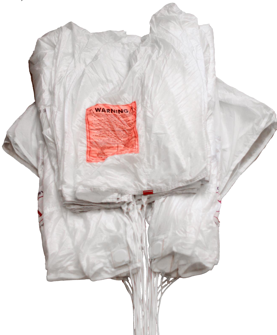
Рисунок 54 – Укладка задней (правой) кромки купола
