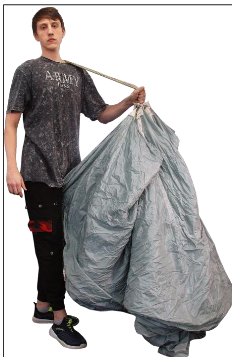
Рисунок 124 – Укладка ОП (фиксация воздухозаборников)
